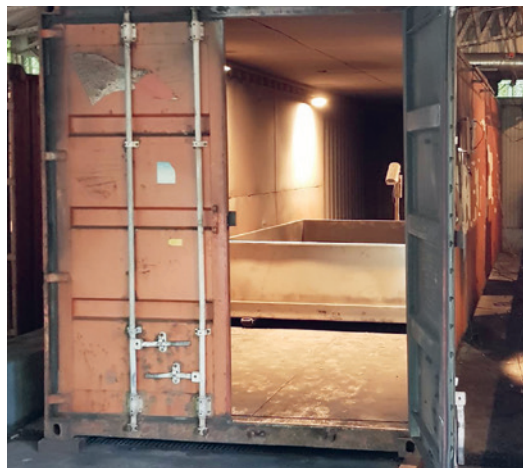
Um ein Vergleichsergebnis zum Versuch im Prüfschrank zu bekommen, diente als alternativer Aufbau eine Wanne in einem Standardcontainer.
