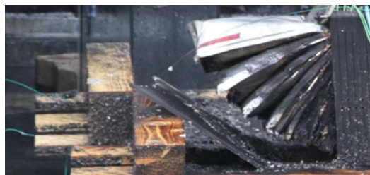
Aus einer früheren Versuchsreihe. Aufgeplatzte Li-Ionen-Batteriezellen.
