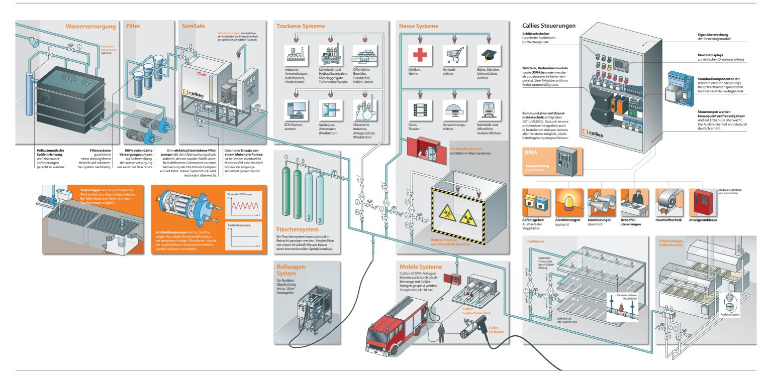
Für jeden Anwendungsfall **DIE PASSGENAUE LÖSUNG**: Unser Anlagenschema visualisiert den Aufbau und die ausgefeilte Technik, die hinter und in unseren Hochdruck-Wassernebel-Löschsystemen stecken. Egal ob stationär, halbstationär oder mobil – wir bieten Ihnen sowohl für
